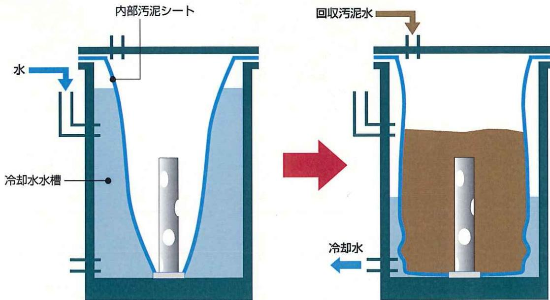
タンク内の特殊二重構造により、カッター作業で使用する冷却水が減った分、内部汚泥シートが膨張し、回収した汚泥水がシート内に貯留される仕組みになっております。完全に分離されているので、カッター冷却水と汚泥水が混合することはありません。もちろん、従来の冷却水タンクのみ利用も可能です。
